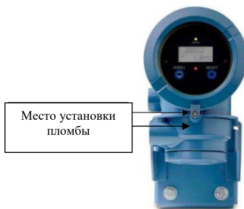
Рисунок 3 – Место установки пломбы для защиты от несанкционированных настройки и вмешательства преобразователя серии 2700
