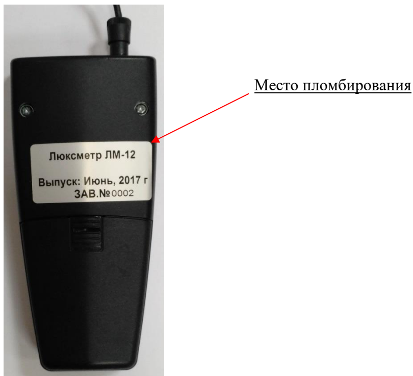
Рисунок 2 – Схема пломбировки люксметров ЛМ-12 от несанкционированного доступа
