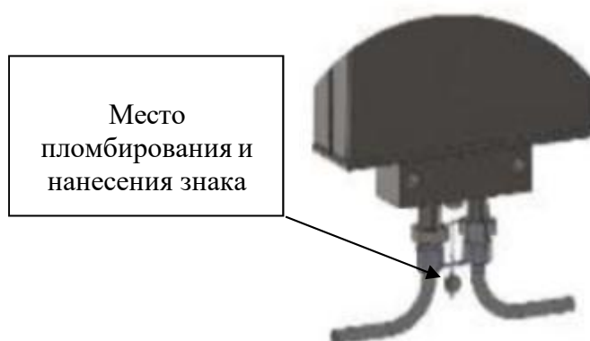
Рисунок 4 – Место пломбирования и нанесения знака поверки на расходомер массовый TSERUS
