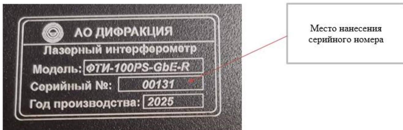
Рисунок 2 – Общий вид маркировочной таблички с указанием места нанесения серийного номера
