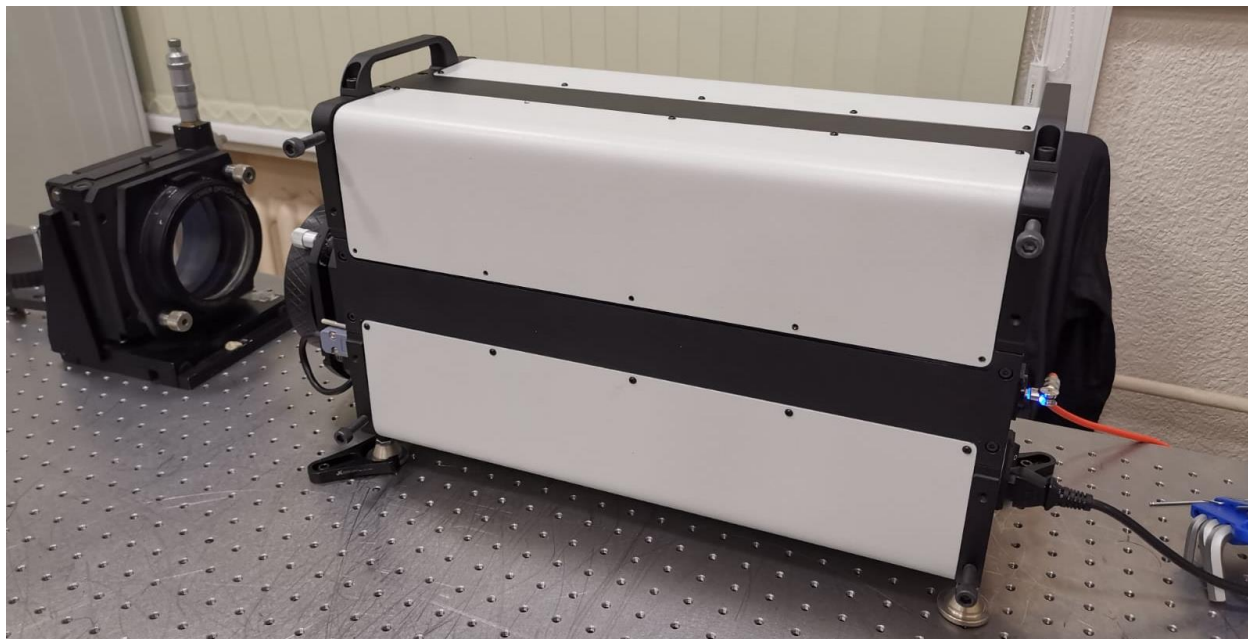
Рисунок 1 – Внешний вид интерферометра лазерного ФТИ
