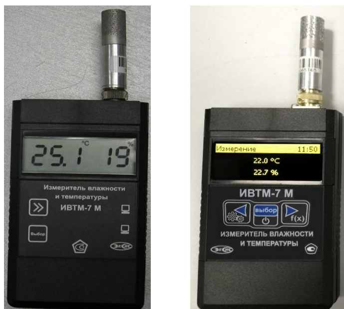
Рисунок 23 – Общий вид измерителя ИВТМ-7 М исполнения ИВТМ-7 М 3 с интерфейсами RS-485 (слева) и Ethernet (справа)
