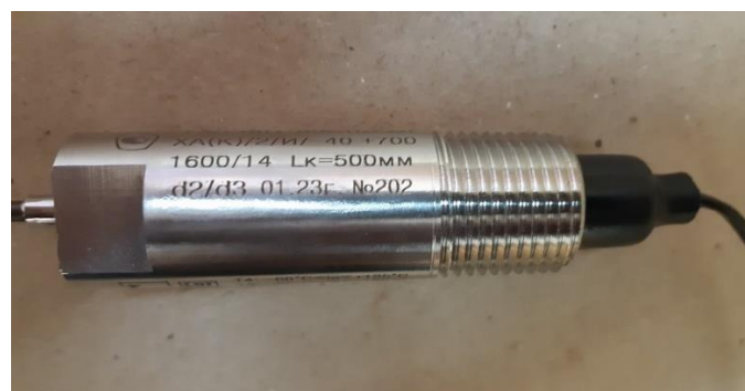
Рисунок 10 – Место нанесения заводского номера методом лазерной гравировки на корпус преобразователя
