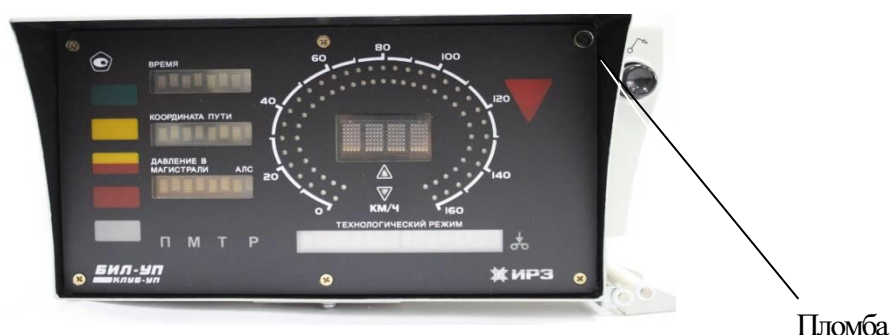
Рисунок 5 – Схема пломбировки от несанкционированного доступа блока БИЛ-УП (невстраиваемый вариант)
