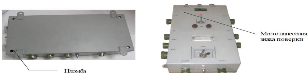
Рисунок 4 - Схема пломбировки от несанкционированного доступа блока БКР-УП
