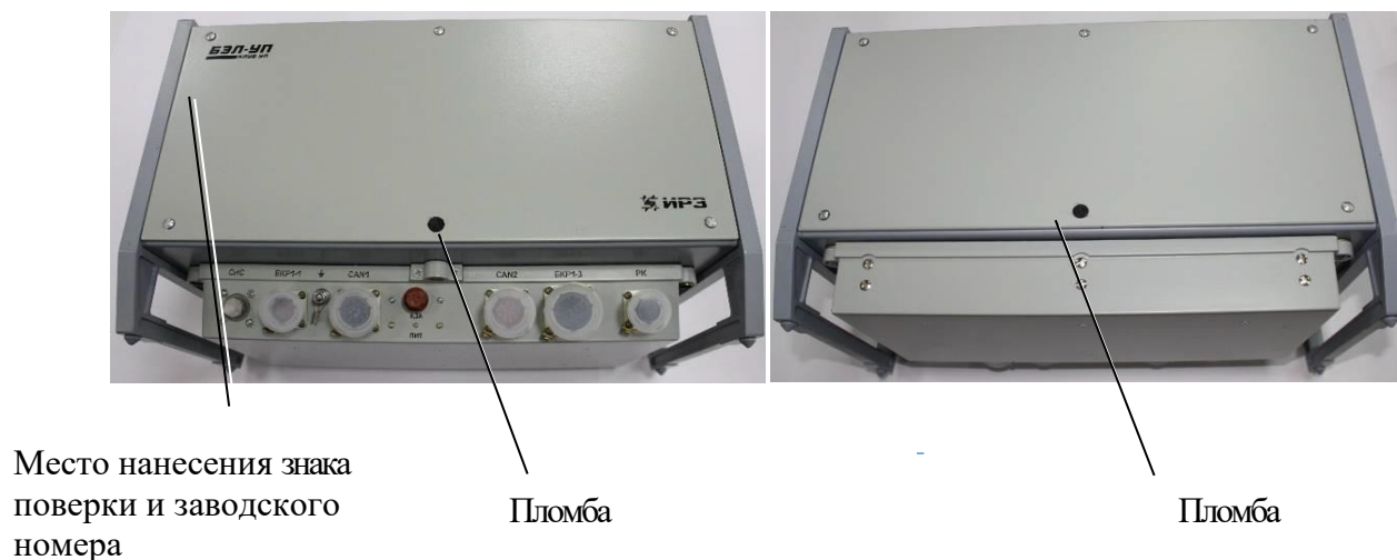
Рисунок 2 – Схема пломбировки от несанкционированного доступа блока БЭЛ-УП, обозначение места нанесения знака поверки и заводского номера
