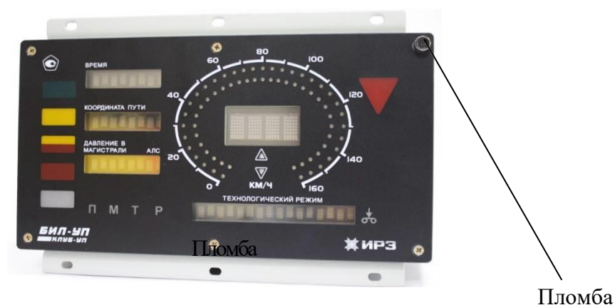
Рисунок 6 – Схема пломбировки от несанкционированного доступа блока БИЛ-УП-01 (встраиваемый вариант)
