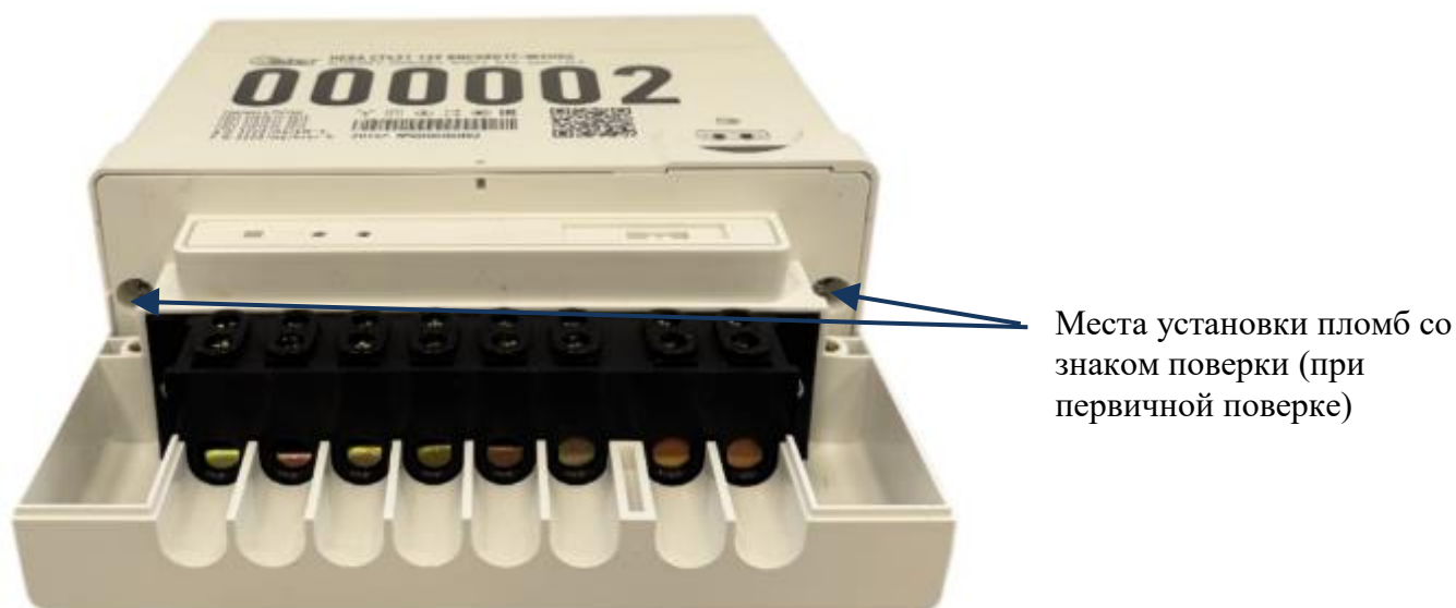
Рисунок 5 – вид счетчиков исполнения НЕВА СТ43Х с местами нанесения знака поверки при первичной поверке
