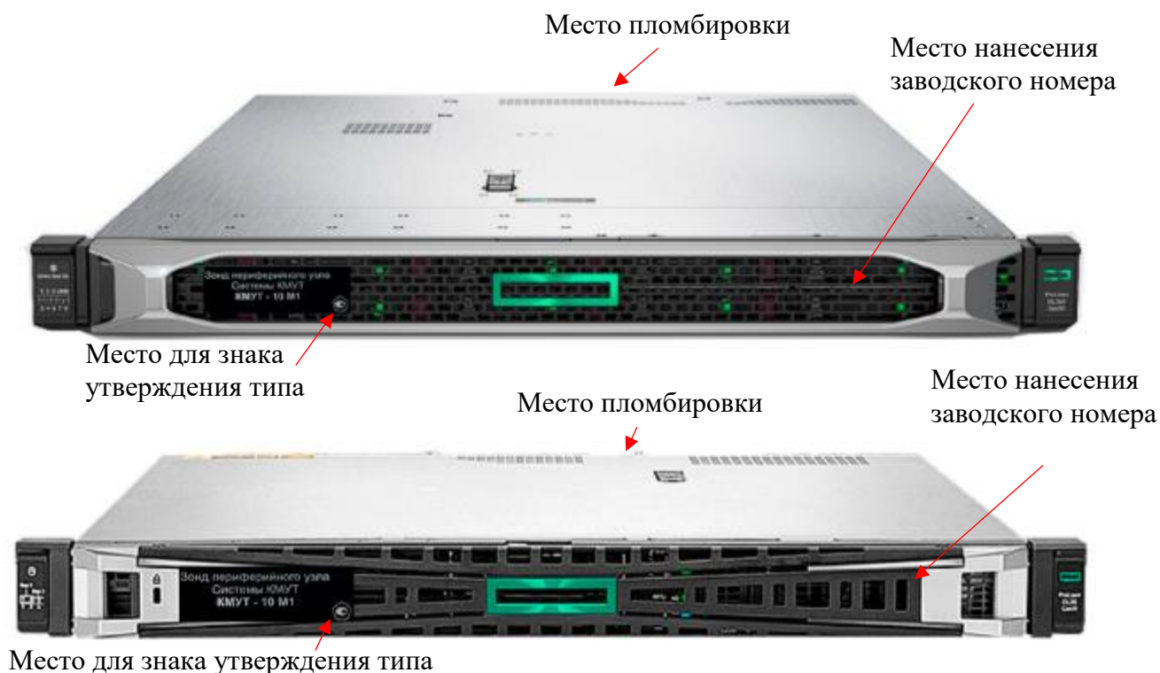
Рисунок 3 – Общий вид зонда КМУТ модификации КМУТ-10 М1. Варианты исполнения в различных корпусах
