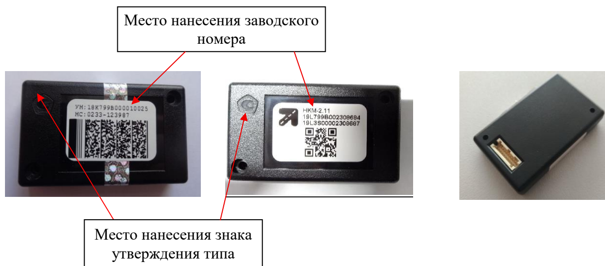
Рисунок 1 – Общий вид блоков, места нанесения знака утверждения типа и нанесения заводского номера
