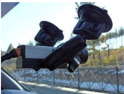
Рисунок 8 – Система видеосъемки РДТ-696.С1 с 1-ой салонной камерой канала «видеосъемка»
