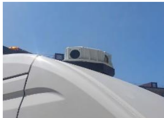
Рисунок 11 – Система видеосъемки РДТ-803 с камерами в едином корпусе канала «видеосъемка»
