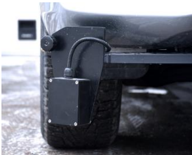
Рисунок 20 – Профилометр дорожный РДТ-806.1 канала «ровность»
