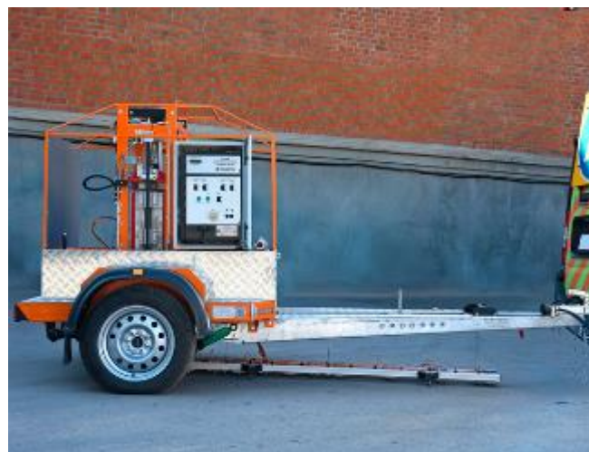
Рисунок 23 – Установка динамического нагружения «Прогибомер FWD-RDT» канала «прочность»
