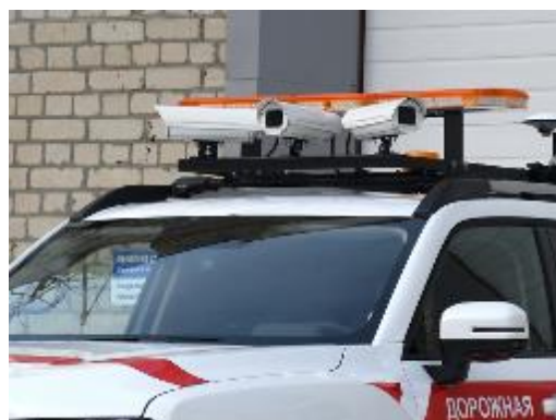
Рисунок 9 – Система видеосъемки РДТ-696.Н3 с 3-мя наружными камерами канала «видеосъемка»
