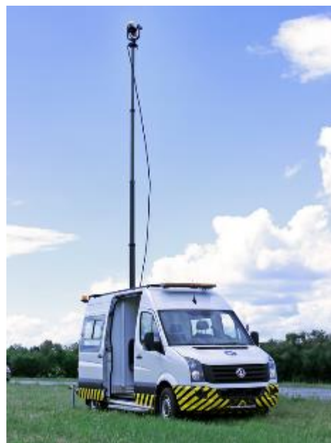
Рисунок 19 – Система учета интенсивности движения ТС РДТ-808 в рабочем состоянии канала «интенсивность»
