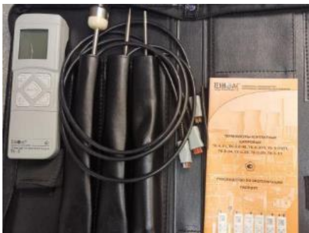
Рисунок 24 – Термометр контактный цифровой ТК-5 производства ООО «ТЕХНО-АС», ООО «НПО ТЕХНО-АС» или ООО «ТД ТЕХНО-АС»
