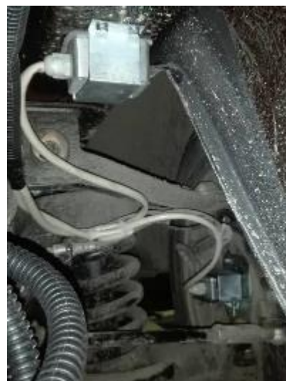
Рисунок 21 – Профилометр дорожный РДТ-806.2 канала «ровность»
