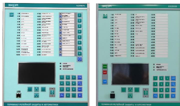
Рисунок 2 – Общий вид терминалов \frac{1}{2} \cdot 19'' конструктива (вид с фронтальной стороны)
