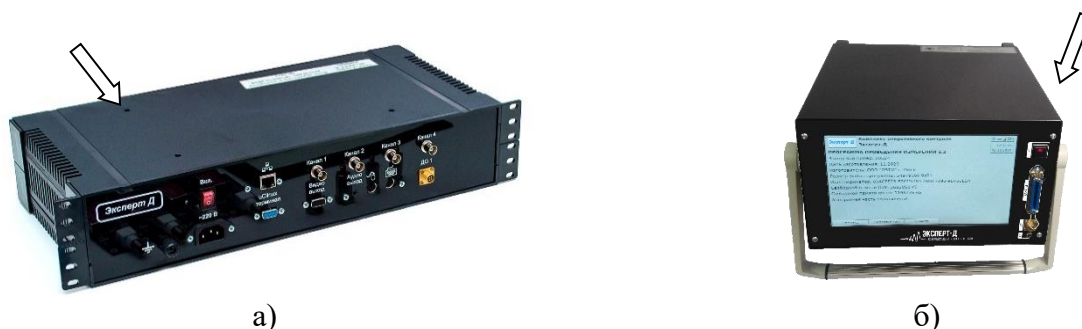
Рисунок 1 – Внешний вид комплексов в стационарном (а) и переносном (б) вариантах исполнения и места их пломбирования (указаны стрелкой)
