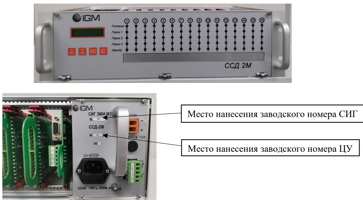
Рисунок 2 – Общий вид ЦУ «ССД-2М» с указанием мест нанесения заводских номеров СИГ и ЦУ
