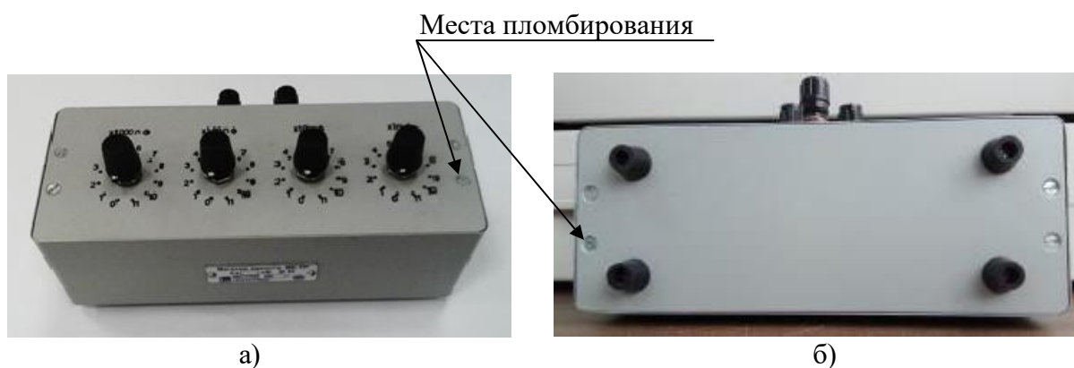
Рисунок 2 – Места пломбирования от несанкционированного доступа
