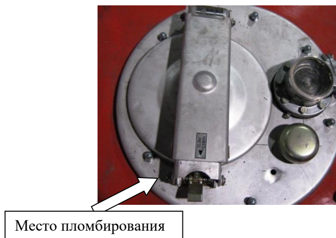
Рисунок 4 – Запорный механизм крышки заливной горловины ПЦ и ППЦ
