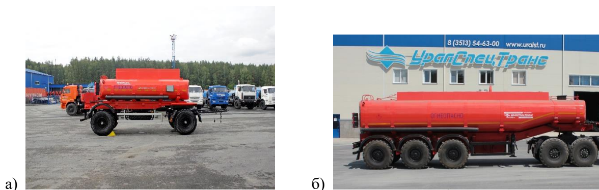
Рисунок 3 – Общий вид а) ПЦ с вариантами исполнения от одной до десяти секций, б) ППЦ с вариантами исполнения от одной до десяти секций.
