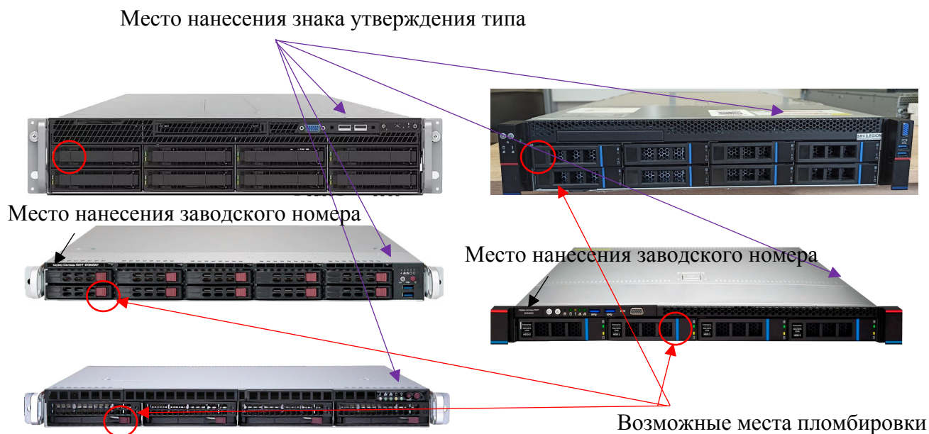
Рисунок 1 – Внешний вид сервера Системы КМУТ (варианты исполнения приборного контейнера)
