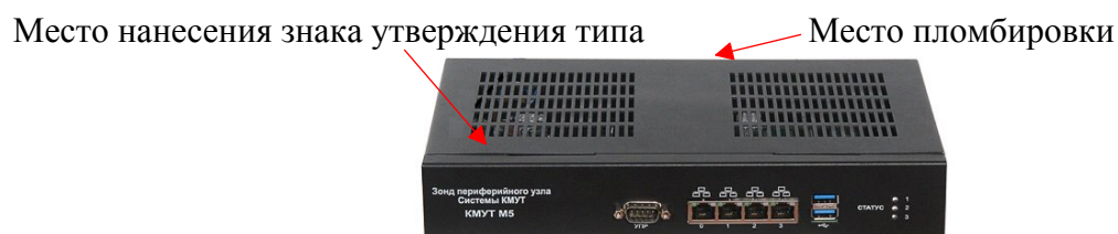
Рисунок 3 – Внешний вид Зонда КМУТ модификации КМУТ М5
