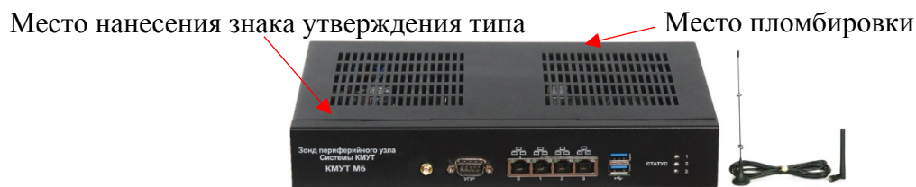
Рисунок 4 – Внешний вид Зонда КМУТ модификации КМУТ М6
