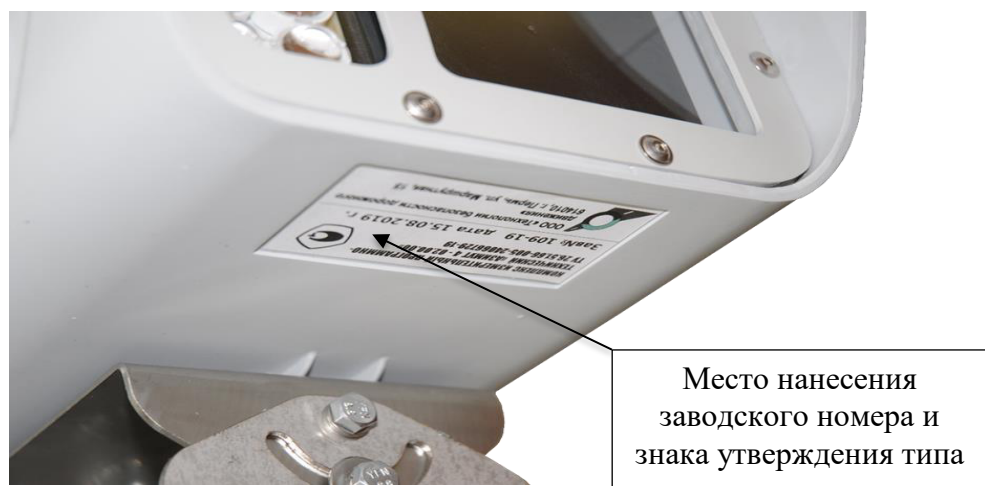
Рисунок 7 – Место нанесения знака утверждения типа и заводского номера комплексов для моноблоков типов 1, 2
