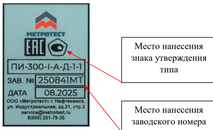
Рисунок 22 – Обозначение места нанесения знака утверждения типа и заводского номера
