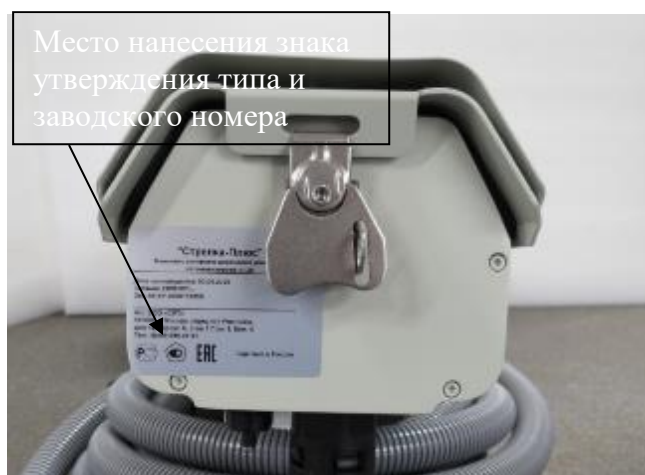
Рисунок 5 – Место нанесения знака утверждения типа и заводского номера на видео модуль
