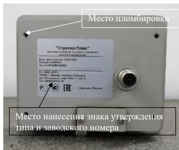
Рисунок 6 – Схема пломбировки и место нанесения знака утверждения типа и заводского номера на 4D модуль
