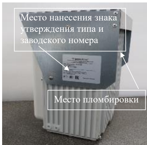
Рисунок 3 – Схема пломбировки RD модуля, место нанесения знака утверждения типа и заводского номера
