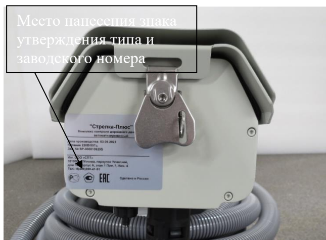
Рисунок 3 – Схема пломбировки RD модуля, место нанесения знака утверждения типа и заводского номера
