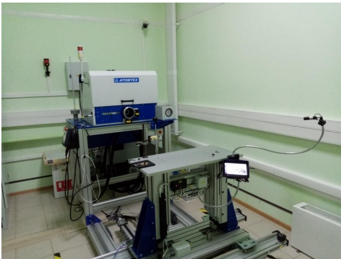
Рисунок 1 – Общий вид установки поверочной рентгеновского излучения УПР-АТ300
