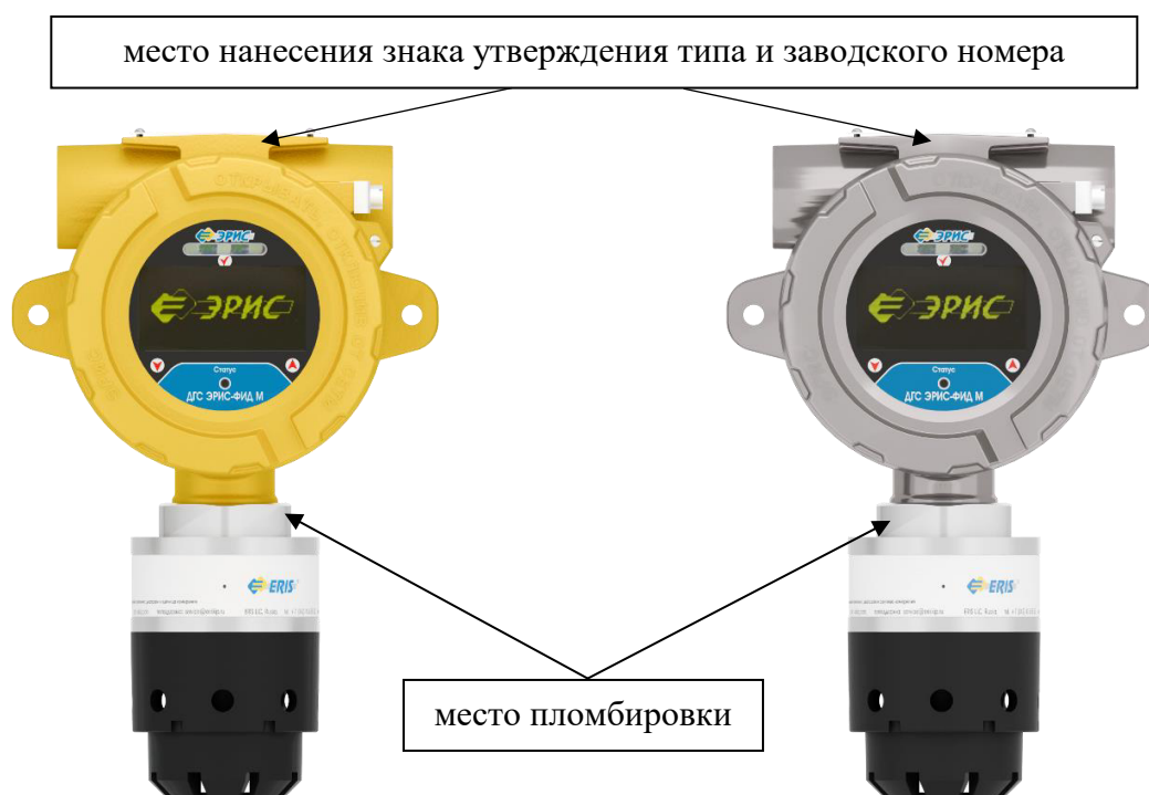
Рисунок 1 – Общий вид газоанализатора стационарного ДГС ЭРИС-ФИД М корпус типа А с указанием мест нанесения знака утверждения типа и заводского номера, мест пломбировки от несанкционированного доступа. Слева-направо: алюминиевый и стальной корпус
