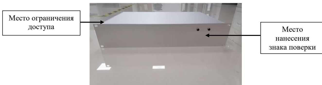
б) Общий вид блока сбора и обработки данных в исполнении для установки в 19"- шкаф-стойку
