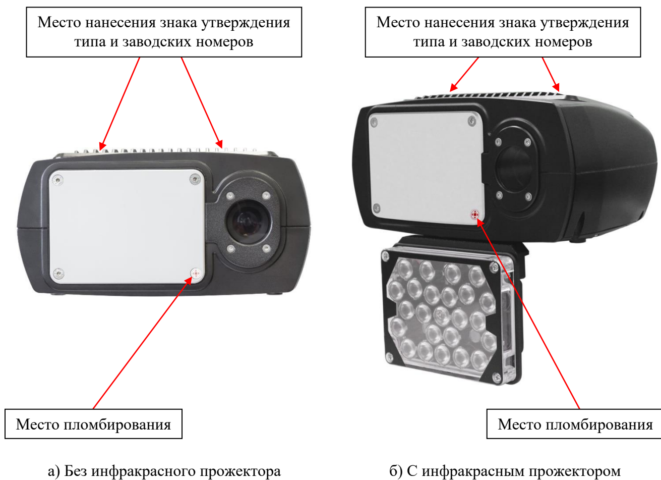
Рисунок 1 – Общий вид ИМ «ОРАКУЛ-Компакт» с указанием места пломбирования, места нанесения знака утверждения типа и заводских номеров
