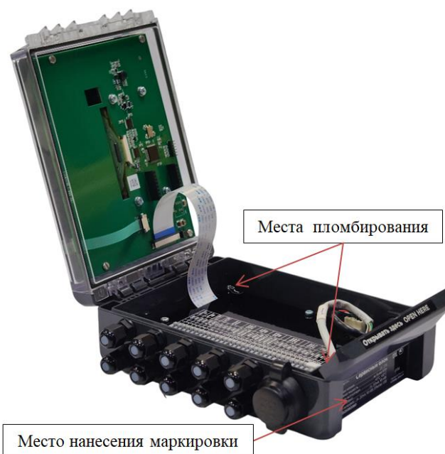
Рисунок 5 – Внешний вид вторичного блока с указанием мест пломбирования и места нанесения маркировки в виде таблички с заводским номером и знаком утверждения типа
