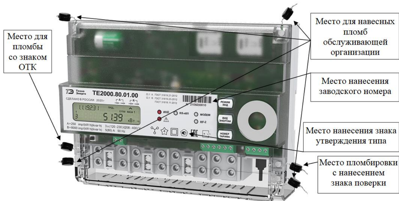
Рисунок 3 – Общий вид счетчика для установки на DIN-рейку с указанием мест пломбировки от несанкционированного доступа, мест нанесения знака утверждения типа, знака поверки, заводского номера
