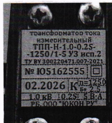
Рисунок 1.2 – Фотографии маркировки трансформаторов тока измерительных ТПП и ТПП-Н (изображение носит иллюстративный характер)
