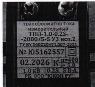
Рисунок 1.1 – Фотографии общего вида трансформаторов тока измерительных ТПП и ТПП-Н (изображение носит иллюстративный характер)
