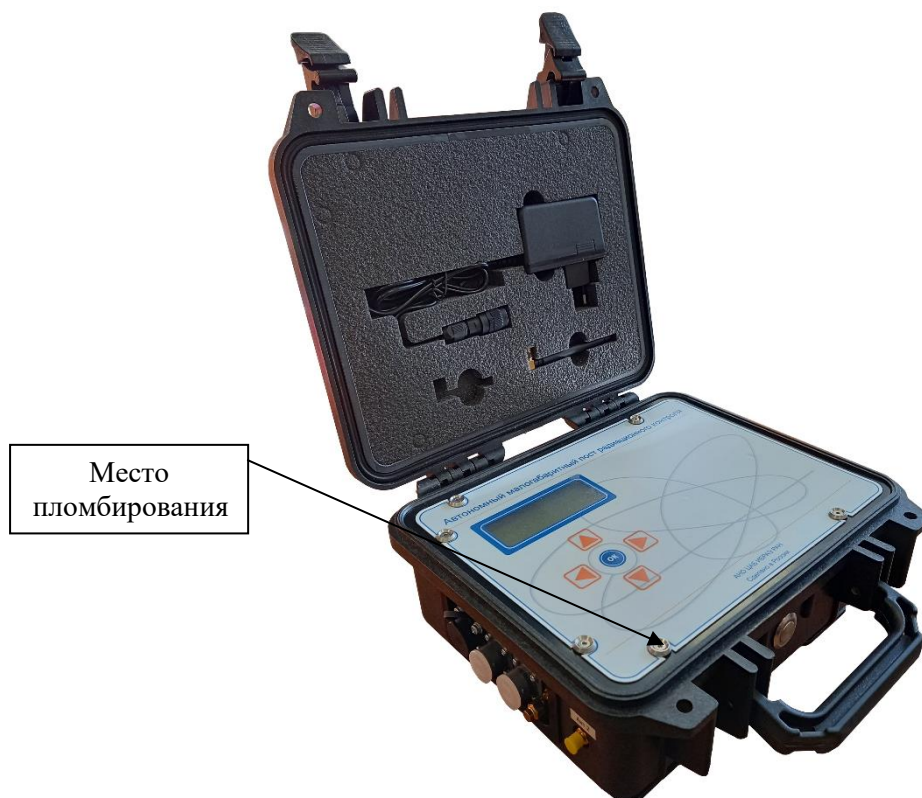
Рисунок 1 – Общий вид АМПК и схема пломбирования от несанкционированного доступа
