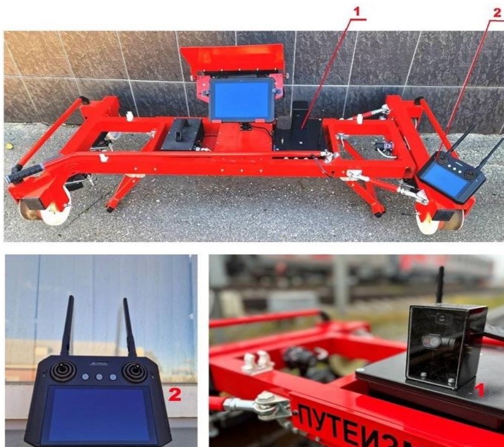
Рисунок 3 – Общий вид тележек путеизмерительных ПТ-12-01 с модулем дистанционного управления (1 – видеочамера, 2 – пульт дистанционного управления)
