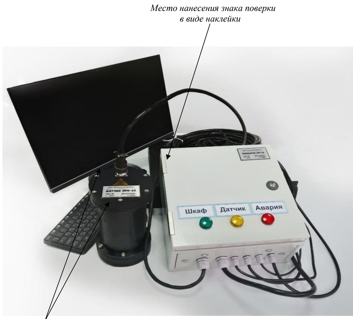
Рисунок 1 – Общий вид анализаторов АРН-1Ц (без системного блока управляющего компьютера), схема пломбировки от несанкционированного доступа и обозначение места нанесения знака поверки в виде наклейки
