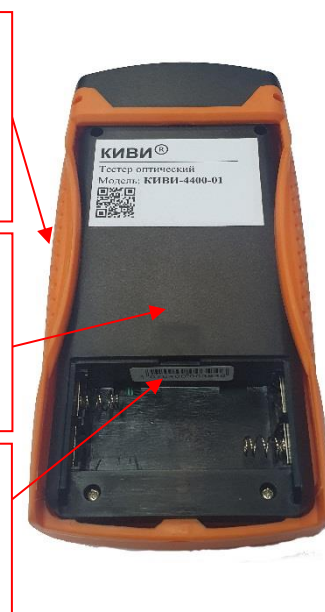
Рисунок 12 – Место нанесения заводского номера, место пломбировки от несанкционированного доступа, место наклейки знака утверждения типа тестеров оптических КИВИ-440У-0Z
