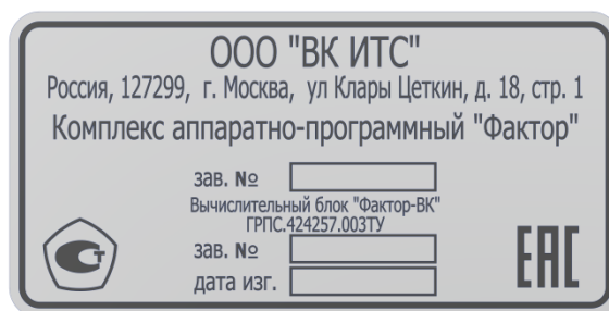
д) Пример маркировки вычислительного блока «Фактор-ВК» (исполнение 2), наносимой на шильд
