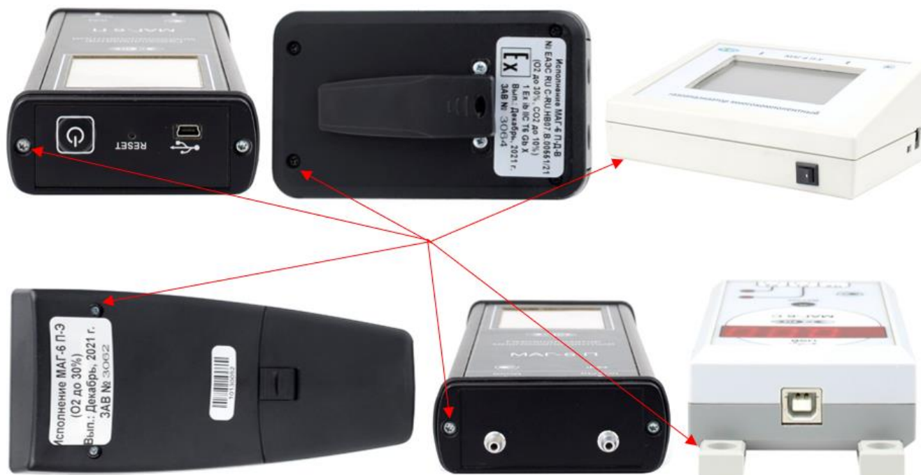
Рисунок 2а – Схема пломбирования от несанкционированного доступа (места пломбирования отмечены стрелками)
