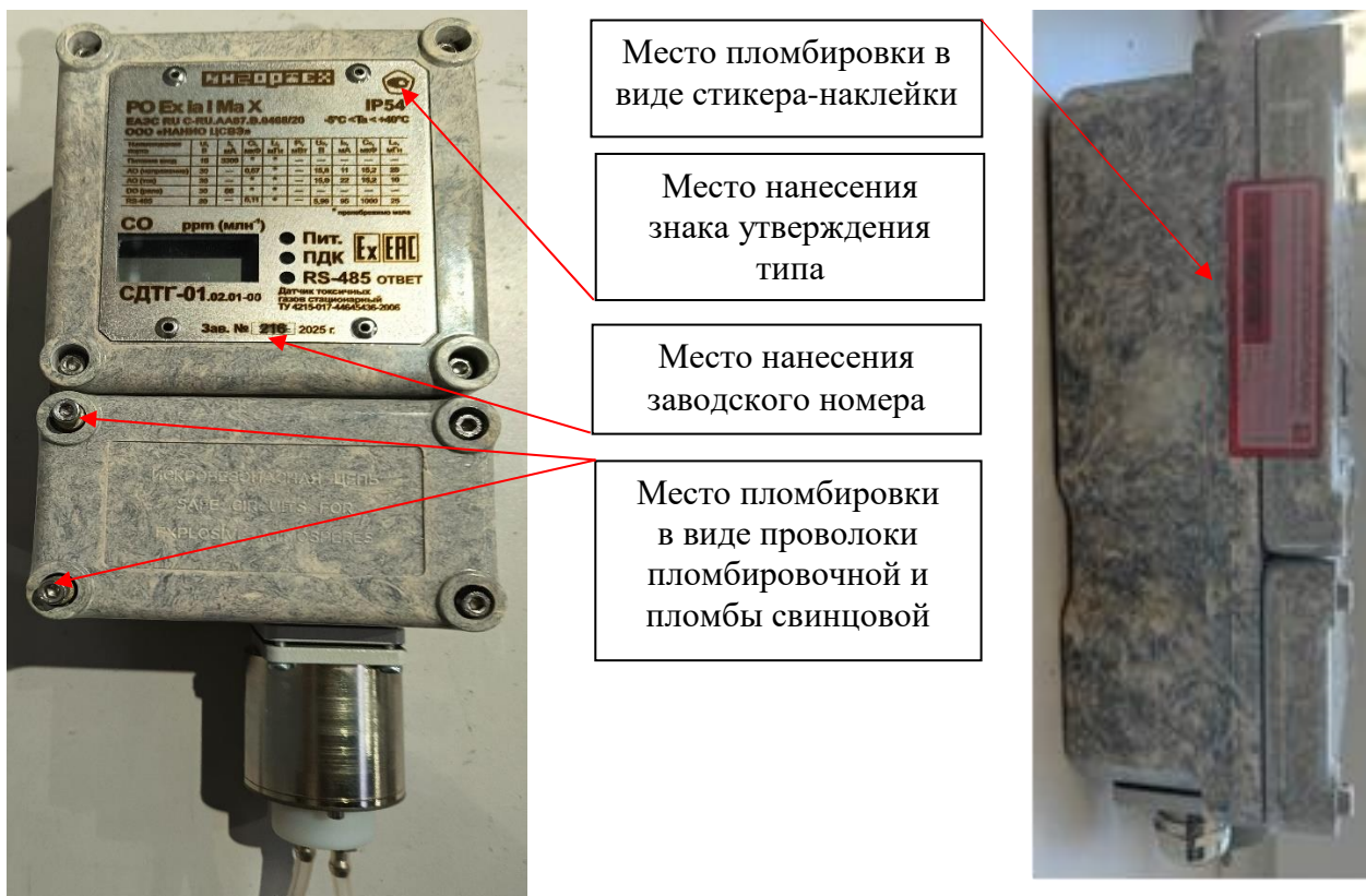
Рисунок 1 – Общий вид датчиков с указанием мест пломбировки, мест нанесения знака утверждения типа, заводского номера
