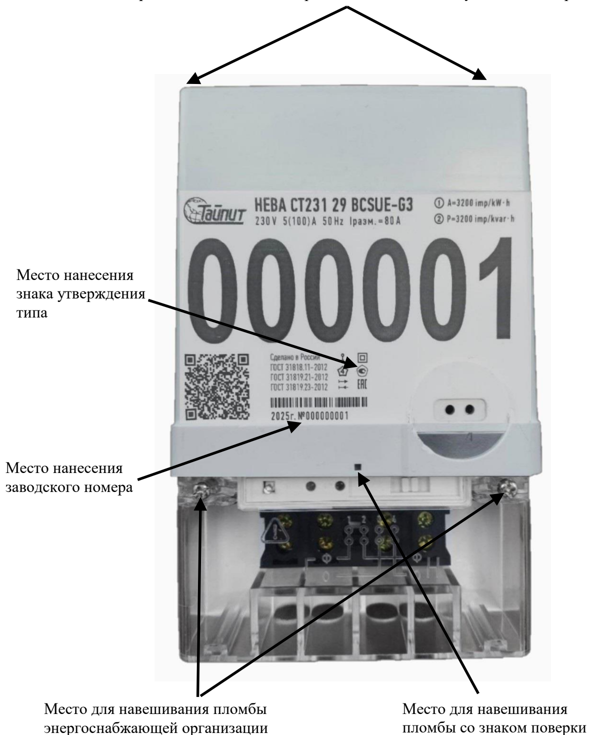
Рисунок 4 – Общий вид счетчиков исполнения НЕВА СТ231 с указанием мест нанесения заводских номеров, знака утверждения типа, а также мест пломбирования
