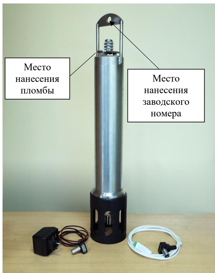
Рисунок 1 – Общий вид зондов гидрологических ОЛД-1 с указанием места пломбировки и места нанесения заводского номера
