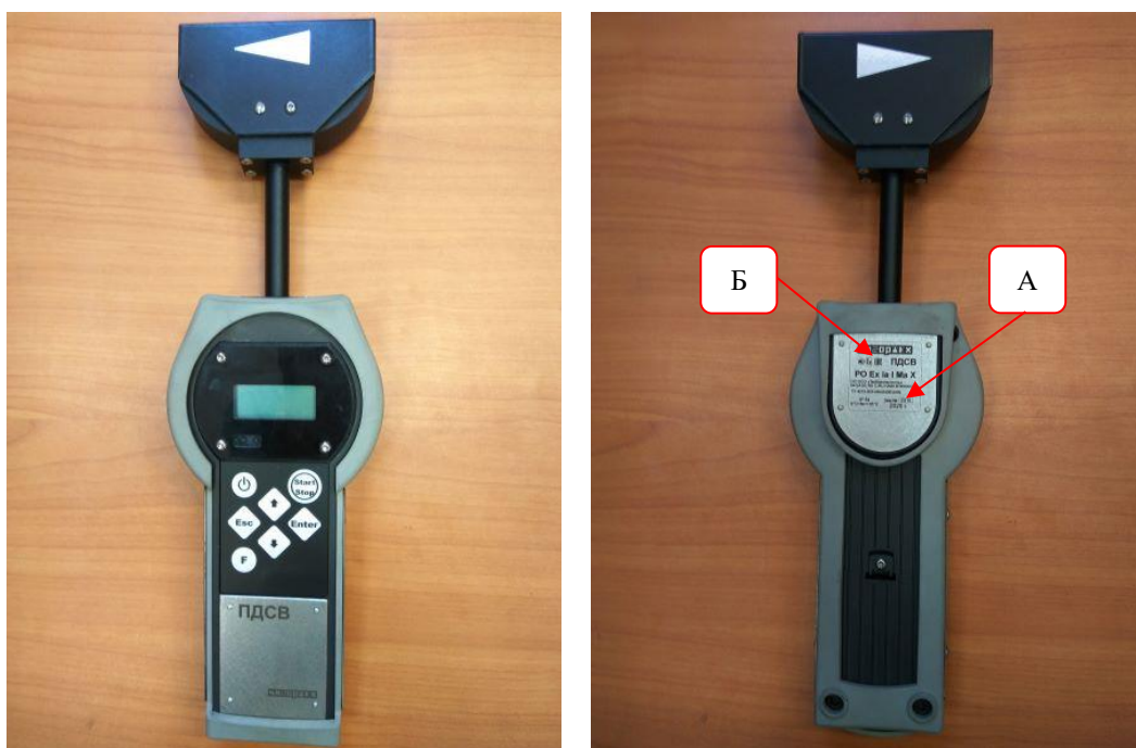
Рисунок 1 – Общий вид измерителя с встроенной головкой в корпусе тип 1; А – место нанесения заводского номера; Б – нанесения знака утверждения типа
