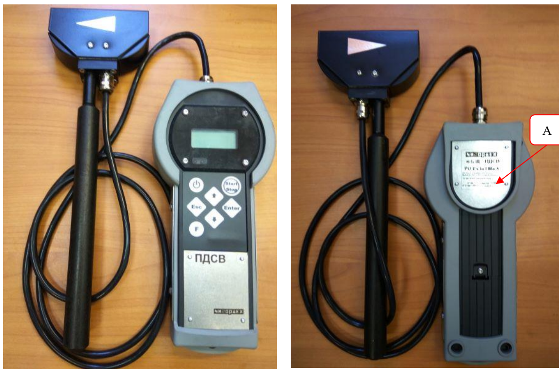
Рисунок 3 – Общий вид измерителя с выносной головкой в корпусе тип 1; А – место нанесения заводского номера
