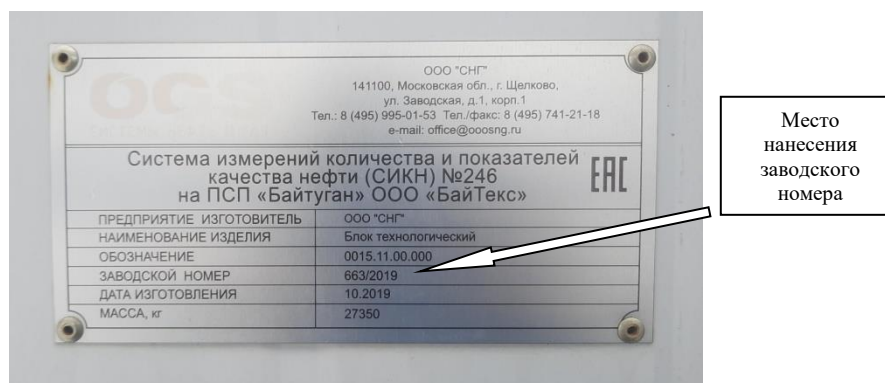
Рисунок 1 – Табличка с указанием места нанесения заводского номера
