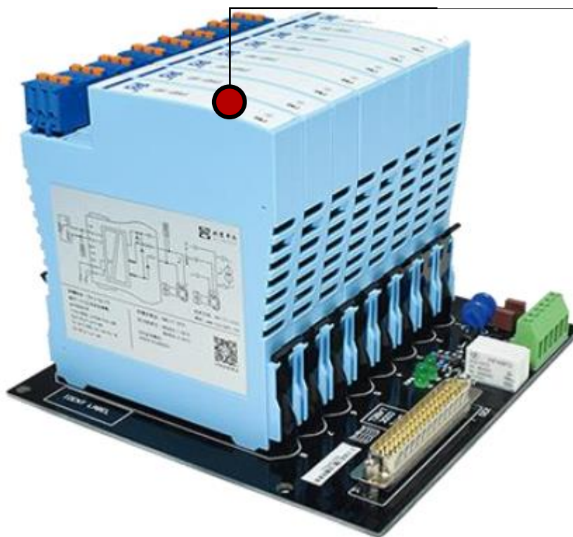
Рисунок 1 – Общий вид преобразователей исполнения «Н» с одним блоком вставных клемм, смонтированные на панель
