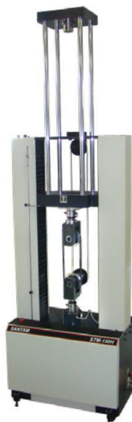
Рисунок 6 – Общий вид машин модификации STM-150H с увеличенным ходом траверсы
