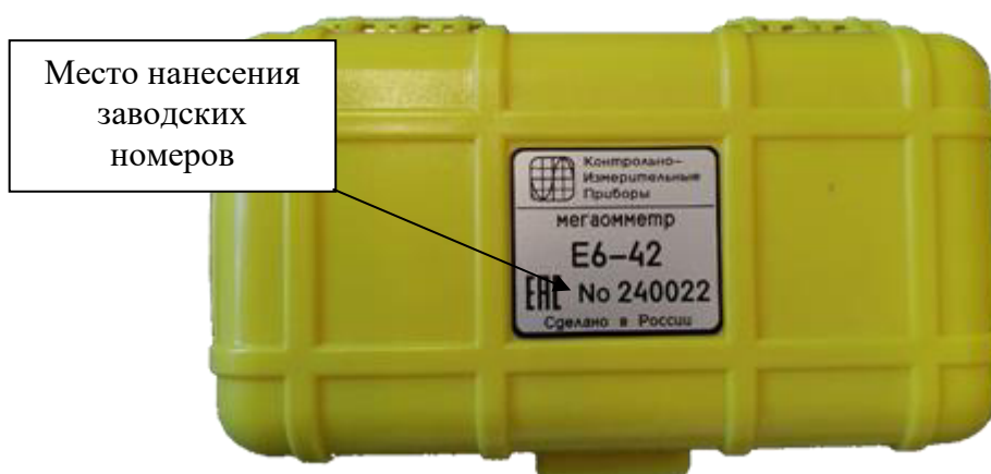
Рисунок 8 – Обозначение места нанесения заводских номеров на мегаомметры Е6 (горизонтальное исполнение корпуса)
