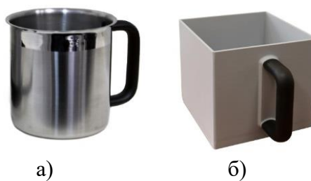
Рисунок 3 – Виды контейнеров для взвешивания а) применяемый в пурке МЕРА; а), б) - применяемые в пурке МЕРА-М
