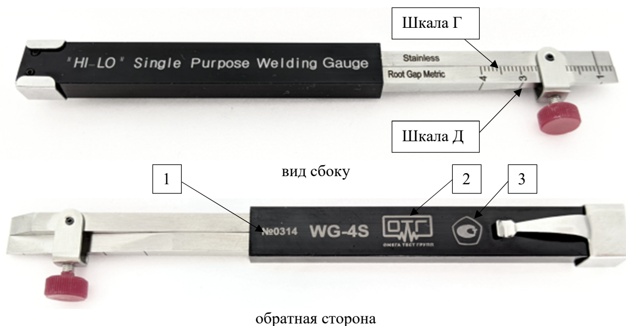
Рисунок 5 – Общий вид шаблона сварщика универсального WG, исполнение WG-4S 1 – место нанесения заводского номера; 2 – логотип изготовителя; 3 – место нанесения знака утверждения типа
