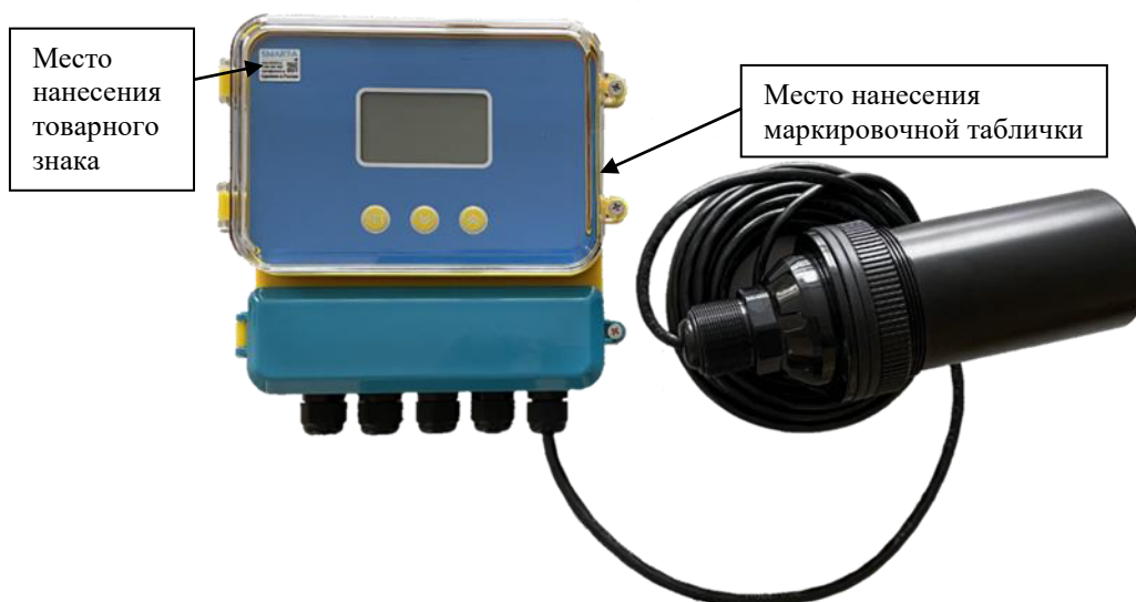
Рисунок 2 – Общий вид преобразователей модификации LU-200
