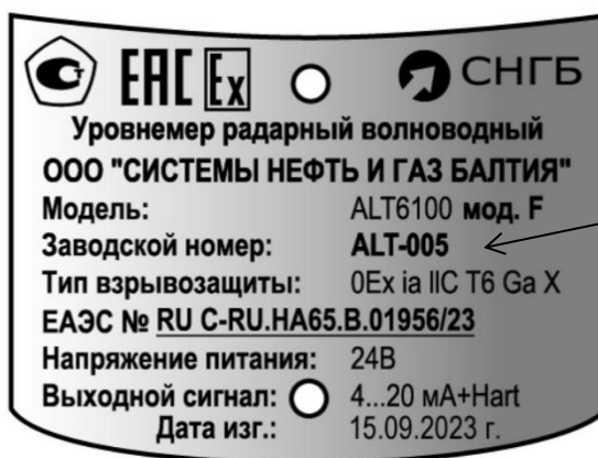
Рисунок 3 – Место нанесения заводского номера и знака утверждения типа
