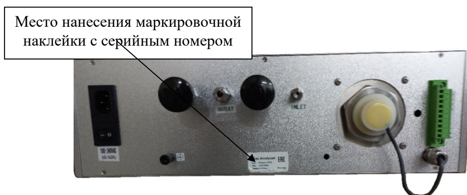
Рисунок 3 – Общий вид газоанализатора PERGAM 6100 исполнение 2 (для измерений содержания O 2 ). Задняя панель
