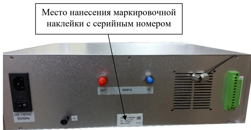
Рисунок 2 – Общий вид газоанализатора PERGAM 6100 исполнение 1 (для измерений содержания CO 2 , N 2 O и N 2 ). Задняя панель
