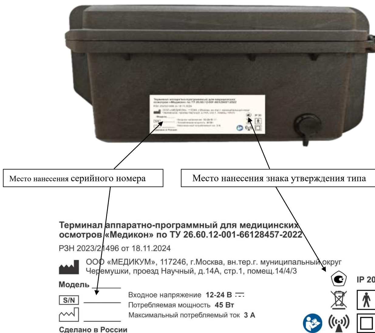
Рисунок 8 – Места нанесения серийного номера и знака утверждения типа модели М8
