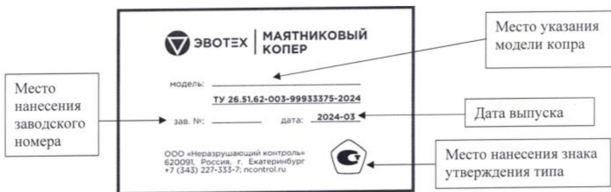
Рисунок 3 – Общий вид маркировочной таблички с обозначением места нанесения заводского номера и знака утверждения типа
