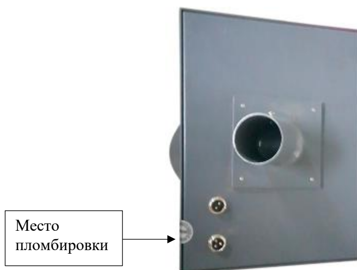
Рисунок 2 – Схема пломбировки от несанкционированного доступа для копров со способом управления с сенсорного дисплея и пульта оператора
