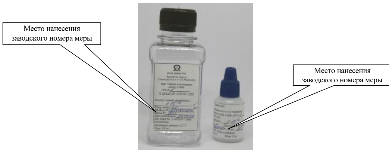
Рисунок 1 – Общий вид мер счетной концентрации частиц в воде МСК-B-1
